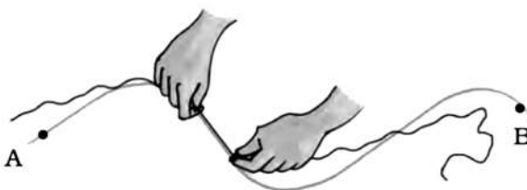
चित्र 1.7: धागे की मदद से वक्र रेखा की लंबाई को मापना
